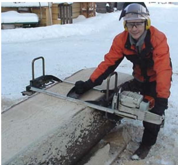
LSG utan linjaler. Stockens plana yta styr nästa skär.
